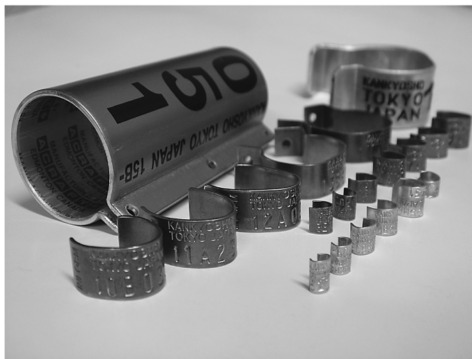
図1. 日本の鳥類標識調査で用いられる金属製の足環。複数のサイズの足環があり、対象種によって適切なサイズの足環が装着される。右手前は小型種用の足環で、内径2 mm、高さ5.5 mm、重さ0.03 g。左の細長いタイプはタンチョウ用で、内径26.5 mm、高さ70.7 mm、重さ70 g。内径はいずれも閉じたときのもの。山階鳥類研究所 (2009) 参照。
